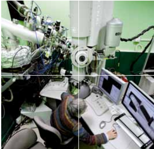
← Microscope électronique en transmission couplé aux deux accélérateurs
