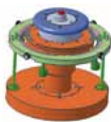
Conception d'outillages d'assemblage d'édifices pyrotechniques
