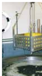
Contrôle densité de l'explosif par poussée hydrostatique
